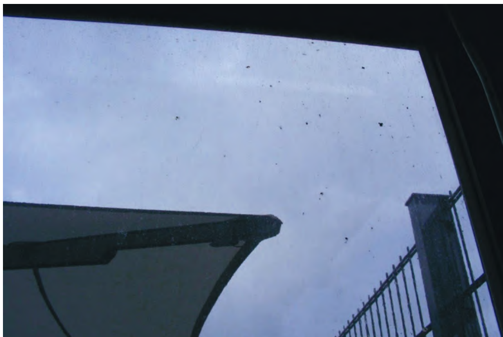
Bild 9.4.5 Am PVC-Sichtfenster können sich Schleif- und Kratzspuren einprägen und Querstreifen entstehen Eine elektrostatische Aufladung kann verstärkt auftreten und zu einer erhöhten Anziehung von Schmutzpartikel führen.
